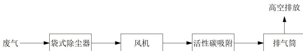
图 2.4-2 VOC 装置工艺流程示意框图
