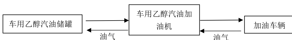
图 2.6-1 车用乙醇汽油加油工艺流程框图（二次油气回收）
