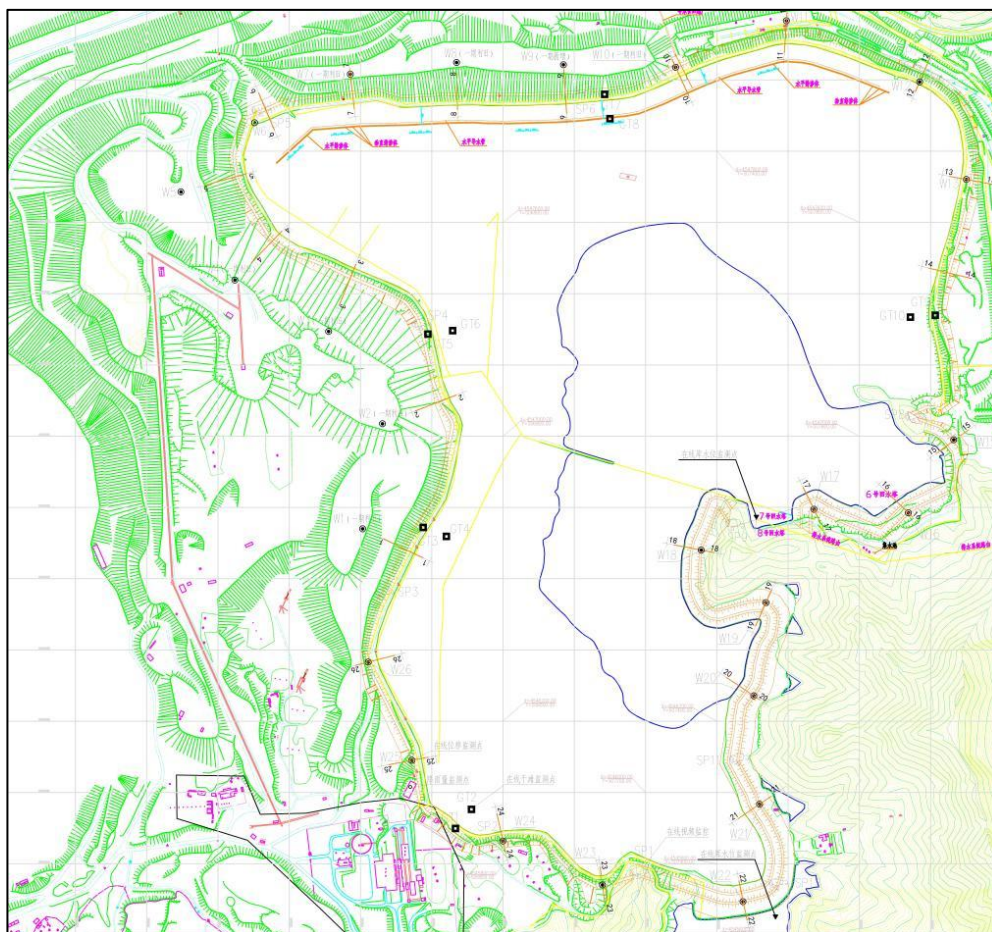
图 2-6 在线监测系统布设位置示意图
