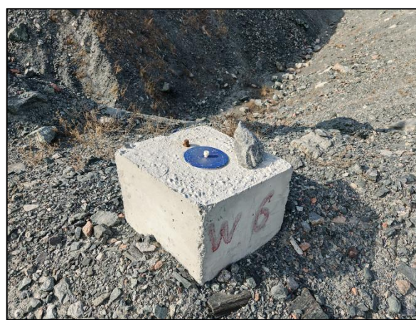
图 2-21 人工表面位移监测点
