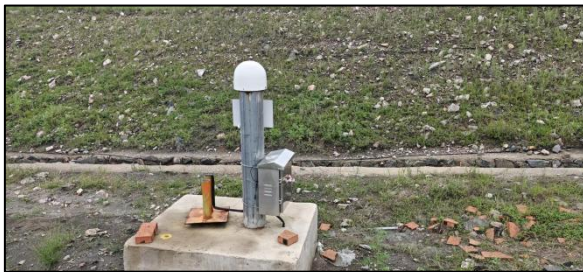
图 2-16 位移及浸润线监测点
