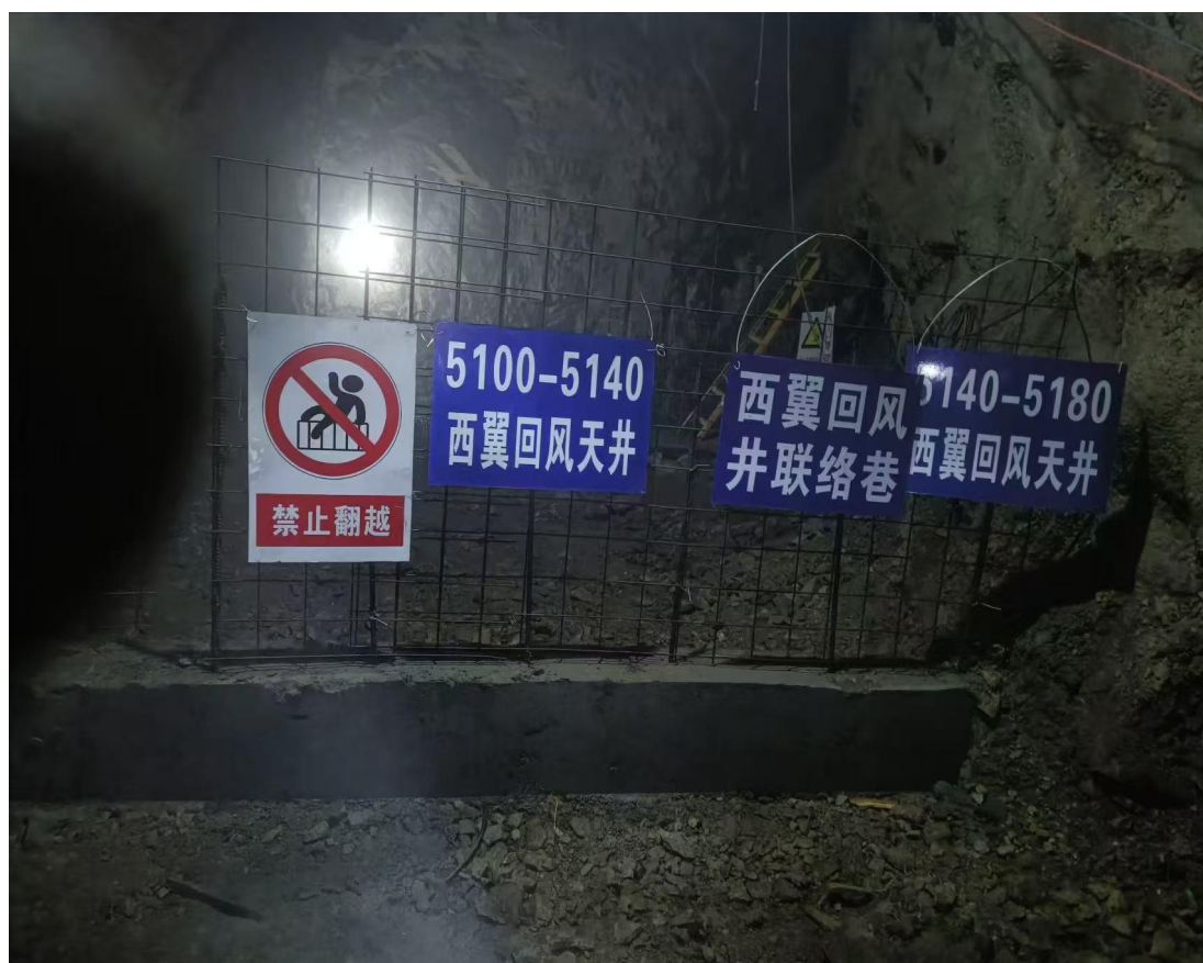
井下回风天井警示标志
