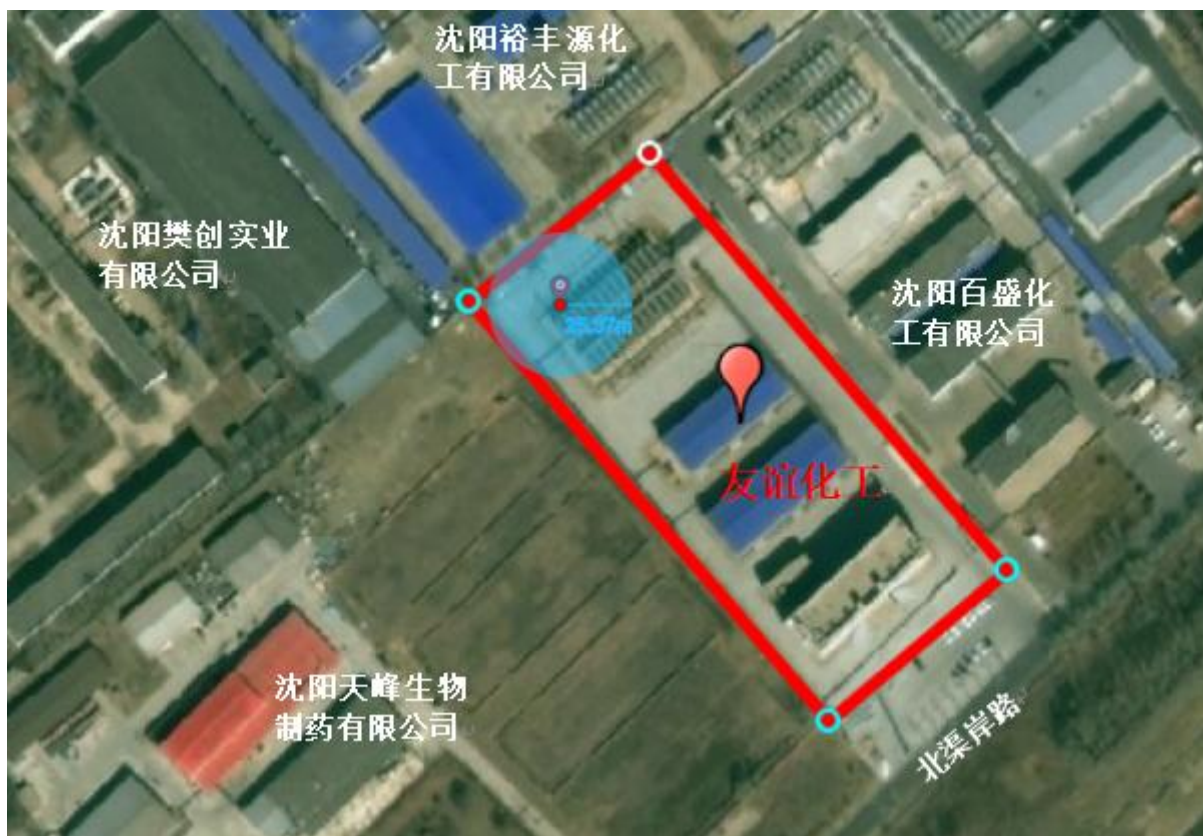
图 5.4-1 多米诺半径（最大值）模拟结果图
