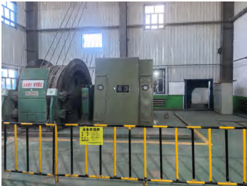
图 3.3-3 5 号混合井提升机、电机
