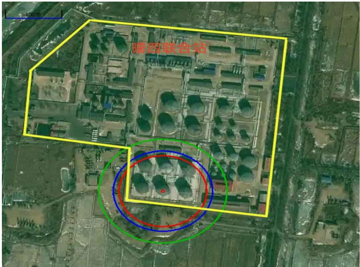
曙四联合站 12#好油储罐整体破裂泄漏池火灾事故后果图
