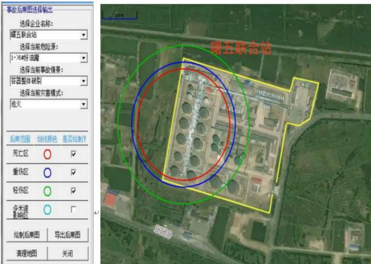
图 7.1-9 曙五联合站 6#好油罐整体破裂泄漏池火灾事故后果图
