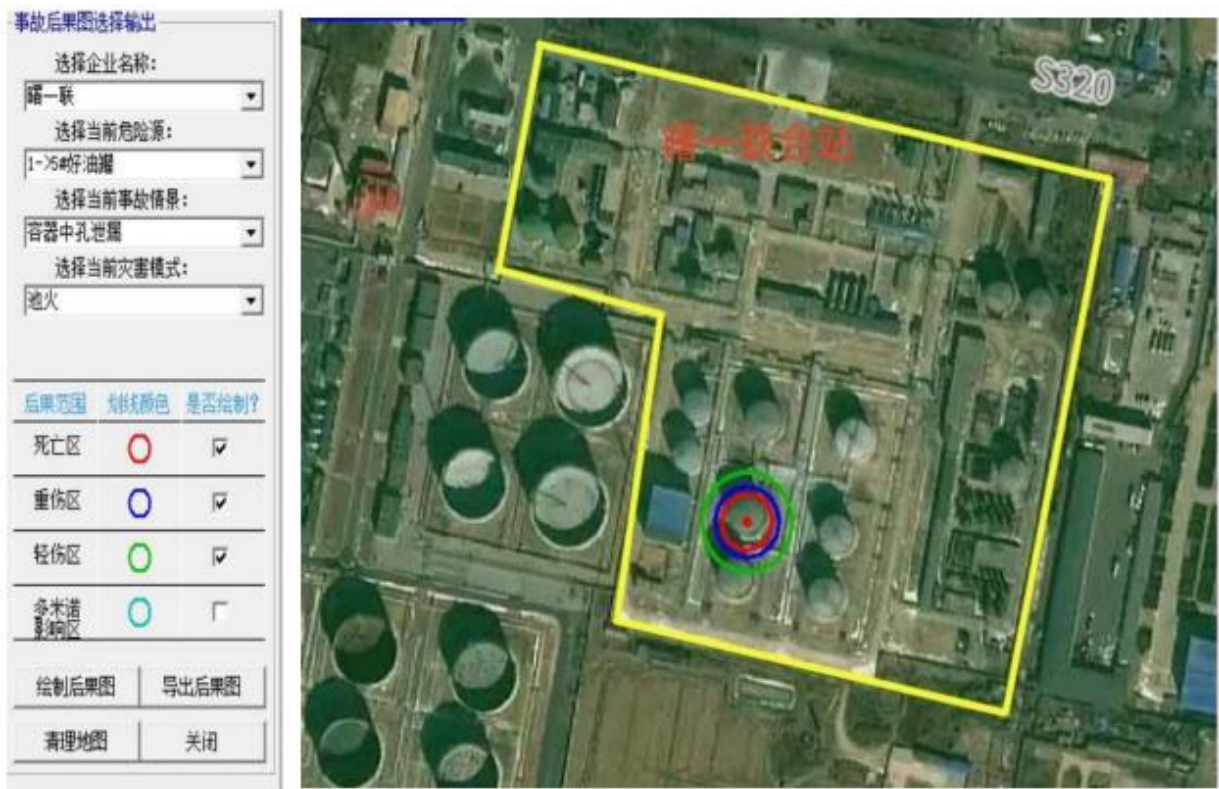
图 7.1-4 曙一联合站 5#好油储罐中孔泄漏池火灾事故后果图
