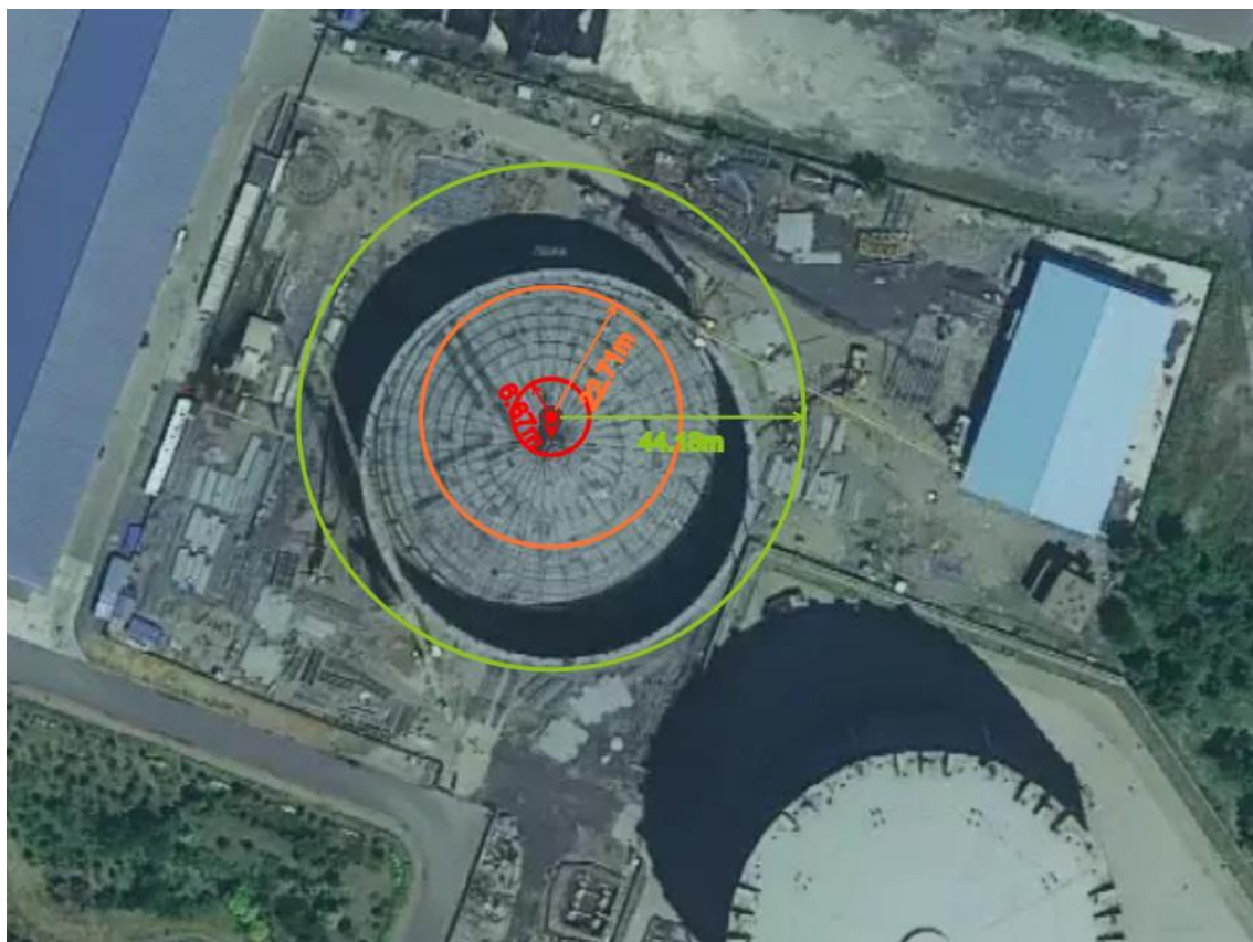
图 5-1 转炉煤气柜蒸气云爆炸事故后果模拟图
