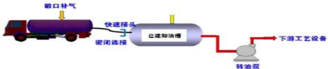
图 2.3-2 原油密闭卸车工艺流程
