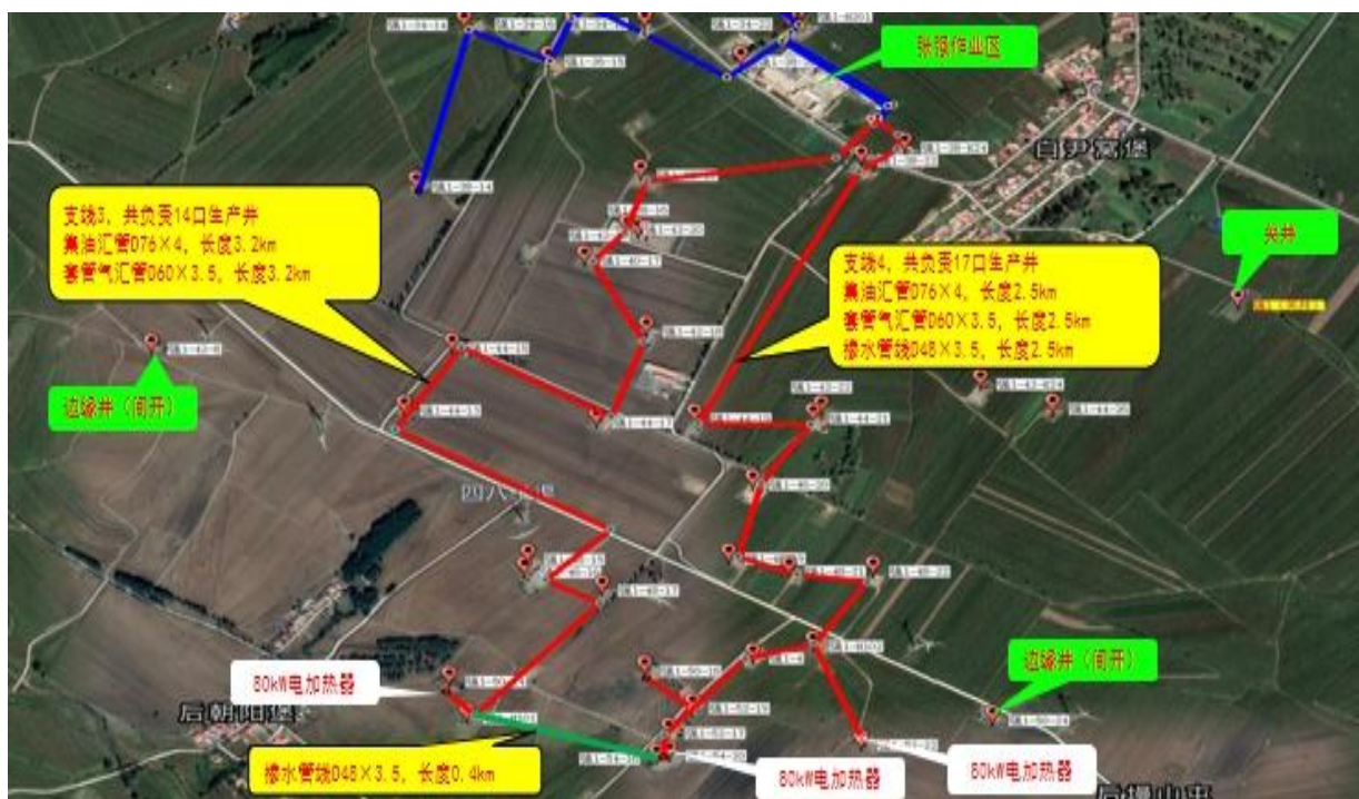
图 2.3-8 支线 3/4 管道走向图
