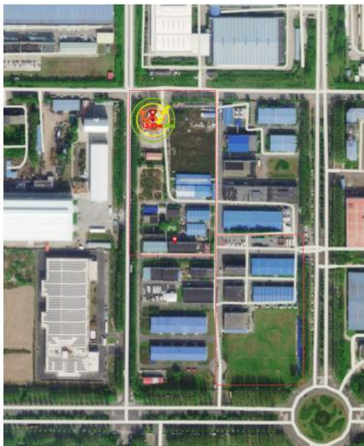
图 3.3-3 环氧丙烷储罐蒸气云爆炸事故后果模拟图
