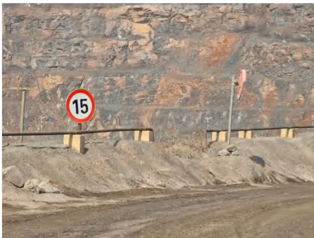
图 2-9 反光镜和限速标志牌
