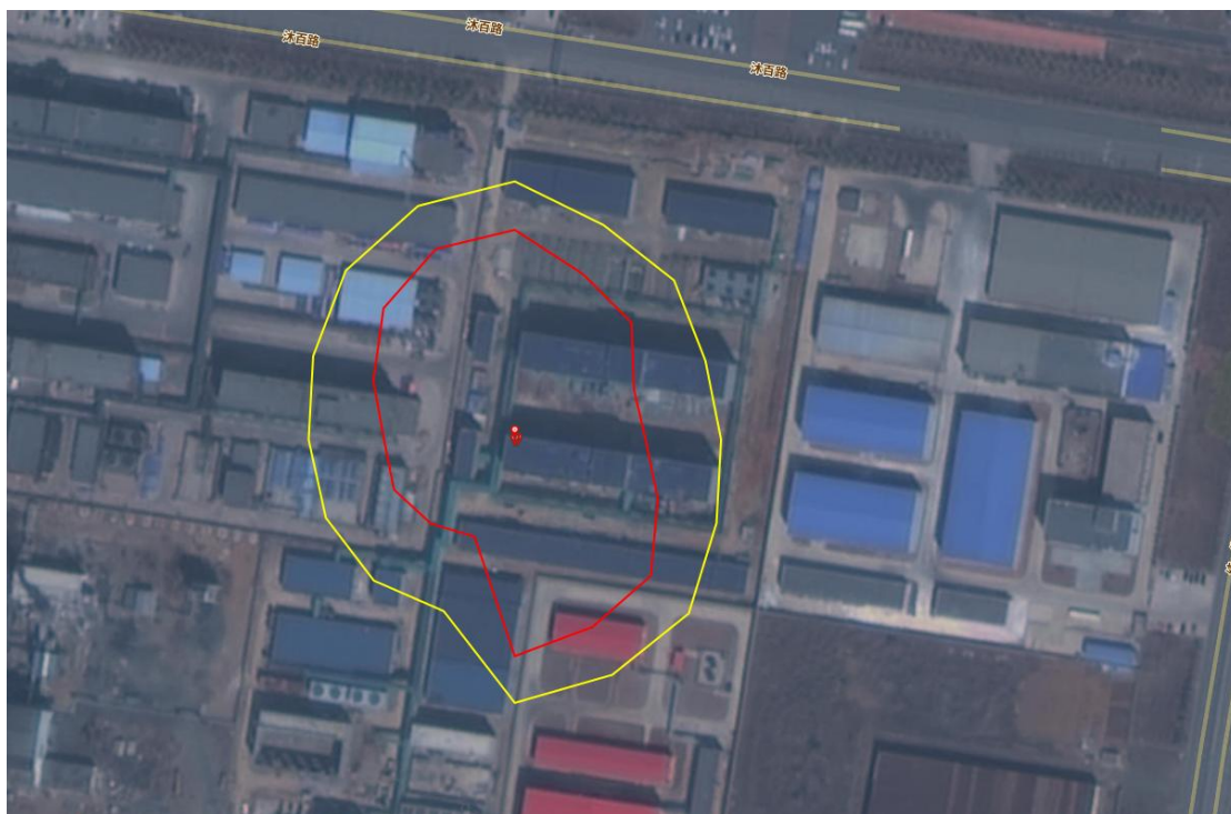
图 4.2-5 七车间液氯钢瓶的外部防护距离图
