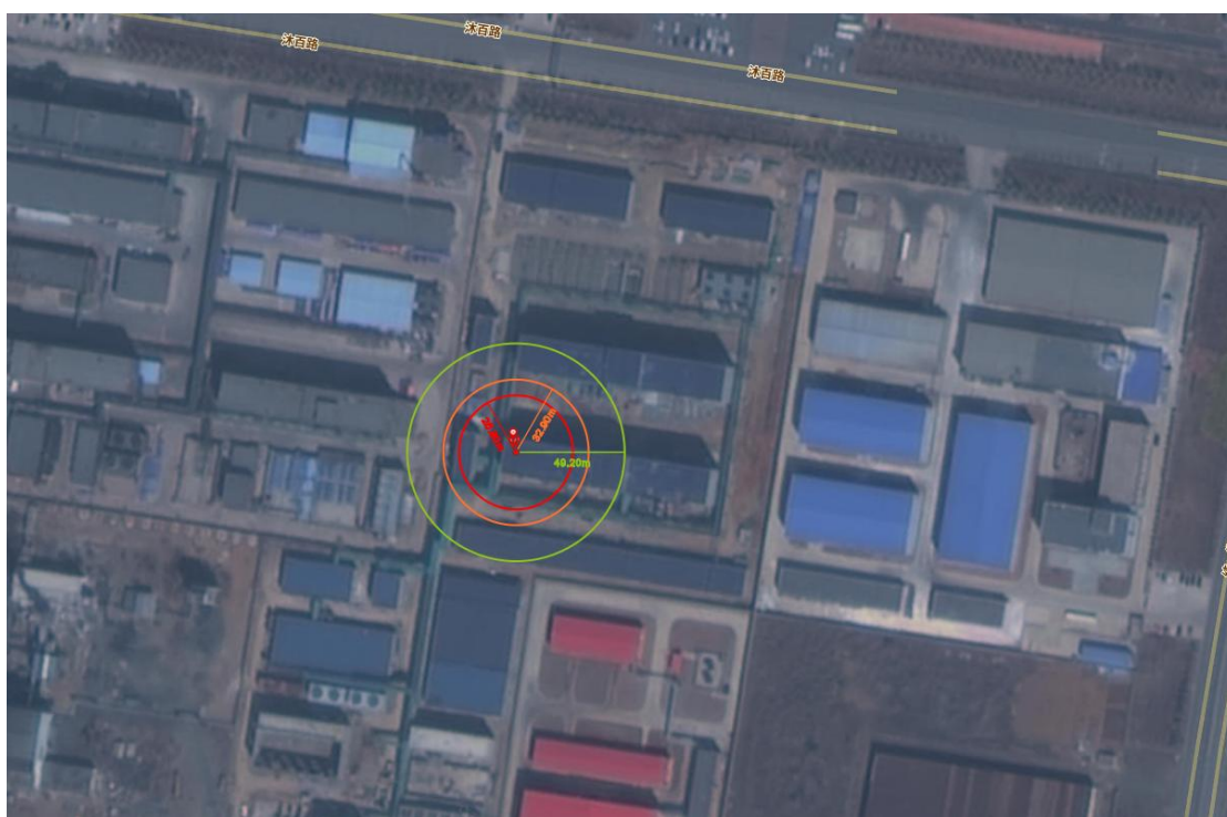
图 3.4-2 喷射火灾事故后果模拟图
